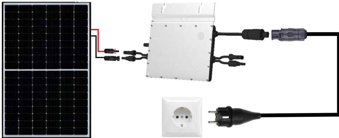
Verkabelung eines Balkonkraftwerks
